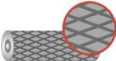
El caucho de revestimiento perfilado SH-A MINI 60 para tambores está destinado a mejorar el coeficiente de rozamiento entre el tambor motriz y la cinta transportadora. Impide el gripado, favorece al movimiento recto de la cinta transportadora, desplaza el agua y barro de ranuras del perfil. Reduce el coeficiente de deslizamiento, aumenta el coeficiente de fricción. Protege el tambor del desgaste y la corrosión.
