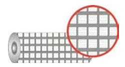
Las planchas de caucho y cerámica SH-A CERAM-GRIP SQ está fabricado de la mezcla especial SBR – caucho estireno-butadieno. Está diseñado para la explotación en condiciones extremas, es muy resistente al desgaste y está preparado para el pegado gracias a su capa adhesiva BL. El caucho de revestimiento tiene vulcanizadas en caliente losetas cerámicas cuadradas texturizadas para un mayor agarre.
